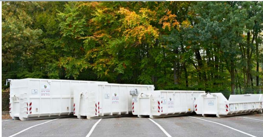
Offene Wechselbehälter mit einem Fassungsvermögen von 10 bis 35 m<sup>3</sup> eignen sich für die Entsorgung großer Abfallmengen, wie sie zum Beispiel im Handel und bei Produktionsbetrieben anfallen. Die Behälter benötigen einen befestigten Untergrund und ausreichende Rangierfläche zum Absetzen oder Aufnehmen.
