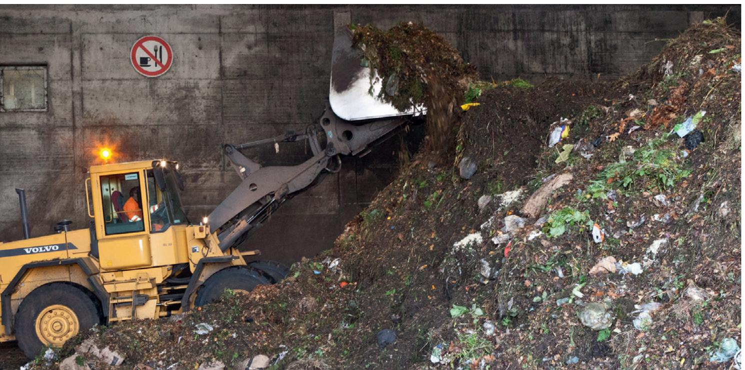
■ Ausgangsmaterial für Biogas und Dünger: 70.000 Tonnen Bioabfall aus Hamburger Haushalten verarbeitet das BKW Bützberg im Jahr.
