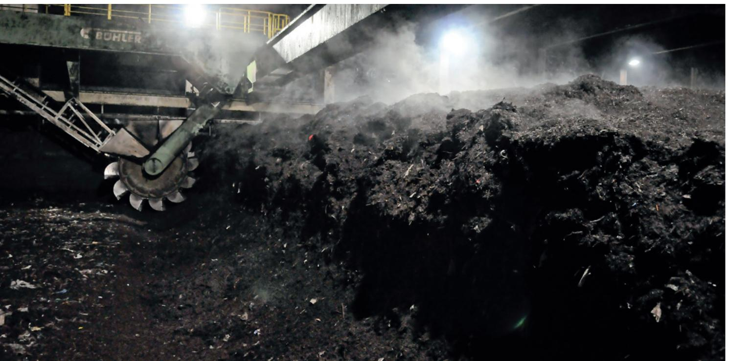
■ "Wendelin" bei der Arbeit: Mehr als nur ein Bagger. Mit drei Meter hohen Schaufelrädern sorgt diese Maschine auch für die nötige Feuchte der Kompost-Mieten.
