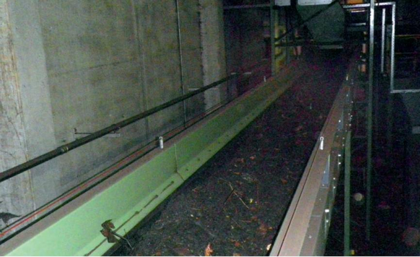
■ Über Förderbänder wird der Bioabfall in die Rottehalle transportiert.
