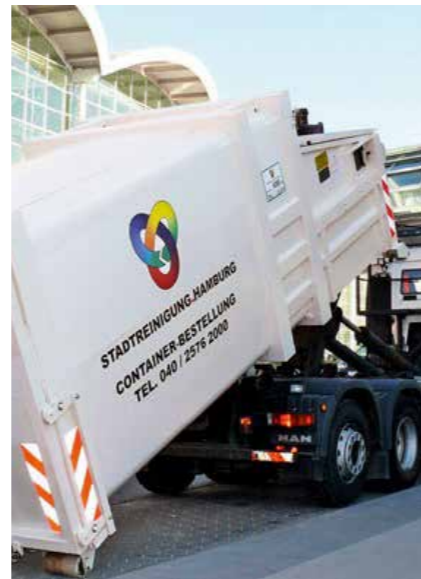
■ Aufnahme eines Presscontainers durch das Entsorgungsfahrzeug.
