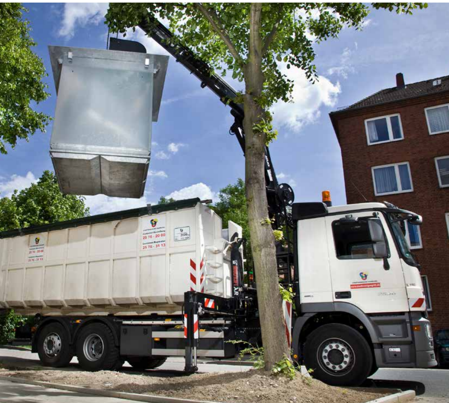
■ Entleerung eines Unterflursystems
