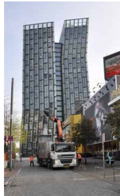
■ Reinigung eines Unterflurbehälters (UFS).
